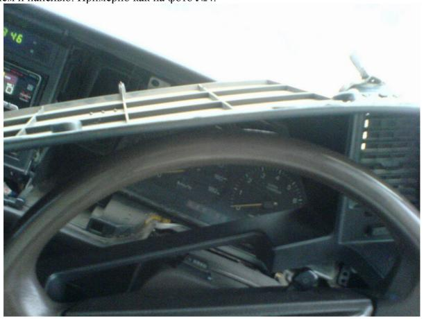
Г) Снятие приборной панели. Она крепиться на 4саморезах фото№5
