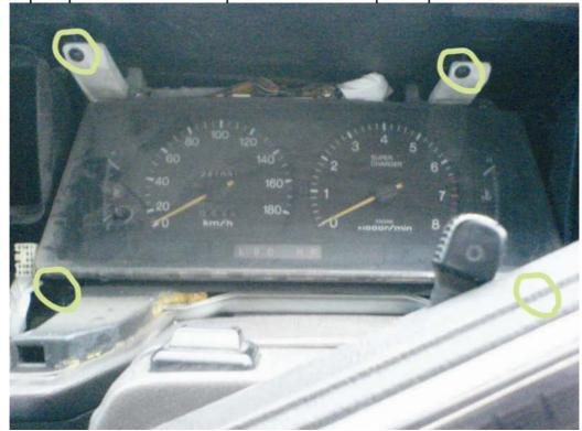
Выкручиваем саморезы, тянем панель немного на себя (этим мы освобождаем захват тросика спидометра), далее надо отсоединить все электрические разъемы с тыльной стороны панели. Вынимаем панель. Фото №6
